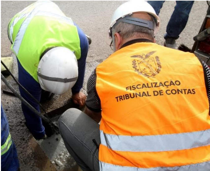
Engenheiros do TCE-PR e funcionários da empresa Dalcon Engenharia retiram amostras de asfalto da Avenida Manoel Ribas, em Curitiba, para análise em laboratório. Foto: Wagner Araújo/Divulgação TCE-PR.
